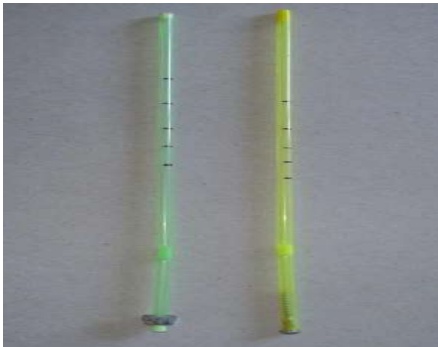
Figura 2. Dos modelos de densímetro contruidos con materiales caseros.
