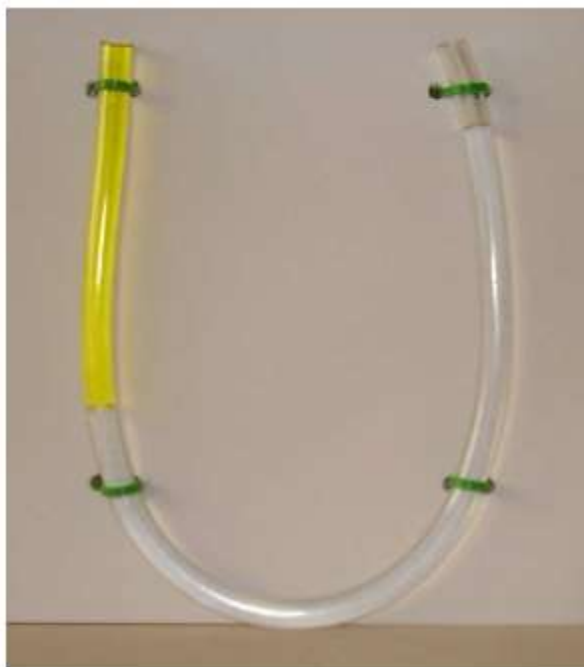
Figura 2. Montaje necesario para determinar la densidad de un líquido utilizando un tubo en U, que se puede construir con una trozo de tubería transparente similar a la que se emplea en los acuarios.
