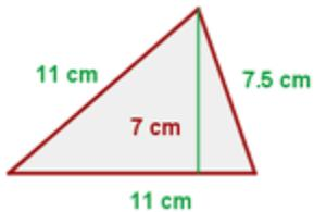
Para calcular el área del triángulo se multiplica la base por la altura y el resultado se divide entre dos.
